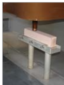
Dressing of drilling bit Ravvatura foretto Dressage foret Aufrauhung der Bohrspitze Avivador broca taladradora
